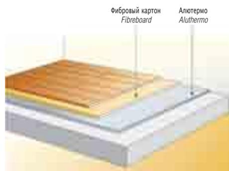
**Установка под дощатым или спрессованным настилом (накладным полом)**
